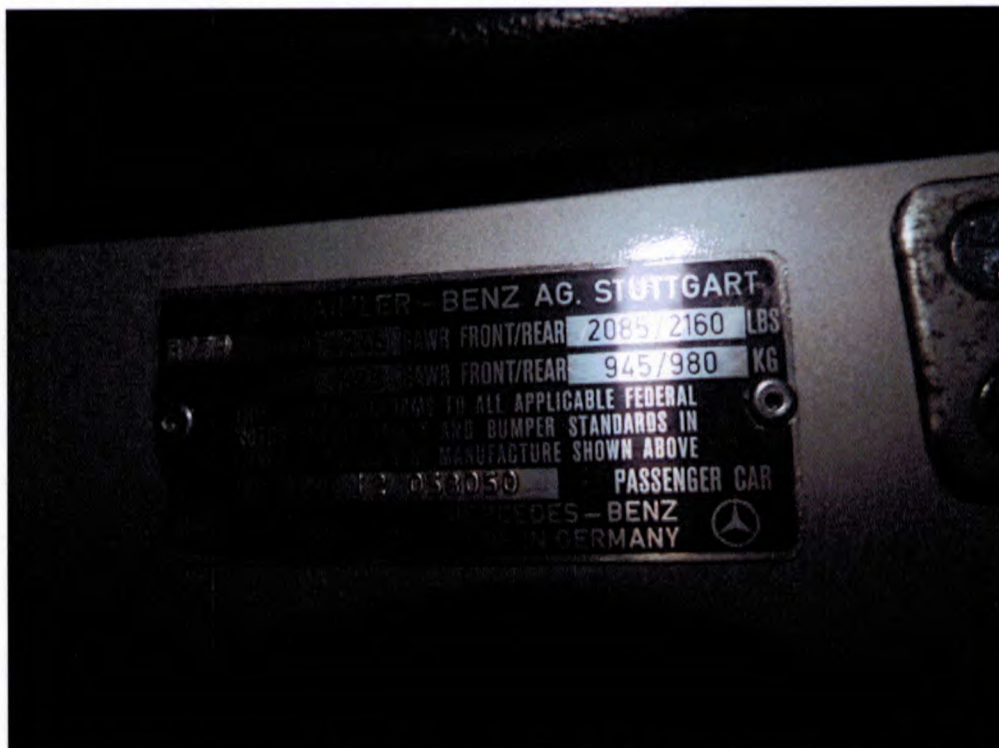
Foto 3 zeigt Typenschild mit den diversen Fahrzeugdaten und der Fahrzeug-Ident-Nr.
