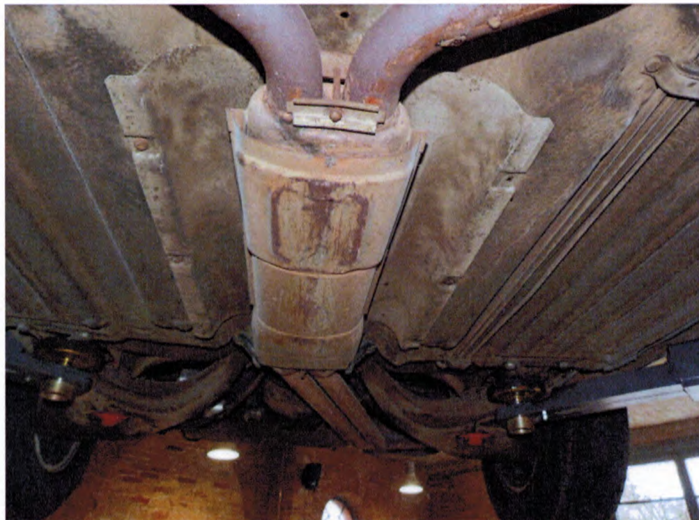
Foto 18 zeigt die Abgasanlage/ Mittelschalldämpfer
