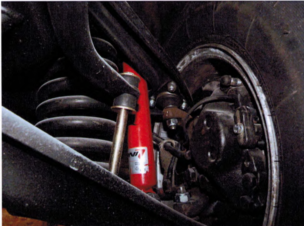
Foto 17 zeigt die Vorderachse sowie der erneuerte Stoßdämpfer und die erneuerten Kugelköpfe des oberen und unteren Achsschenkels
